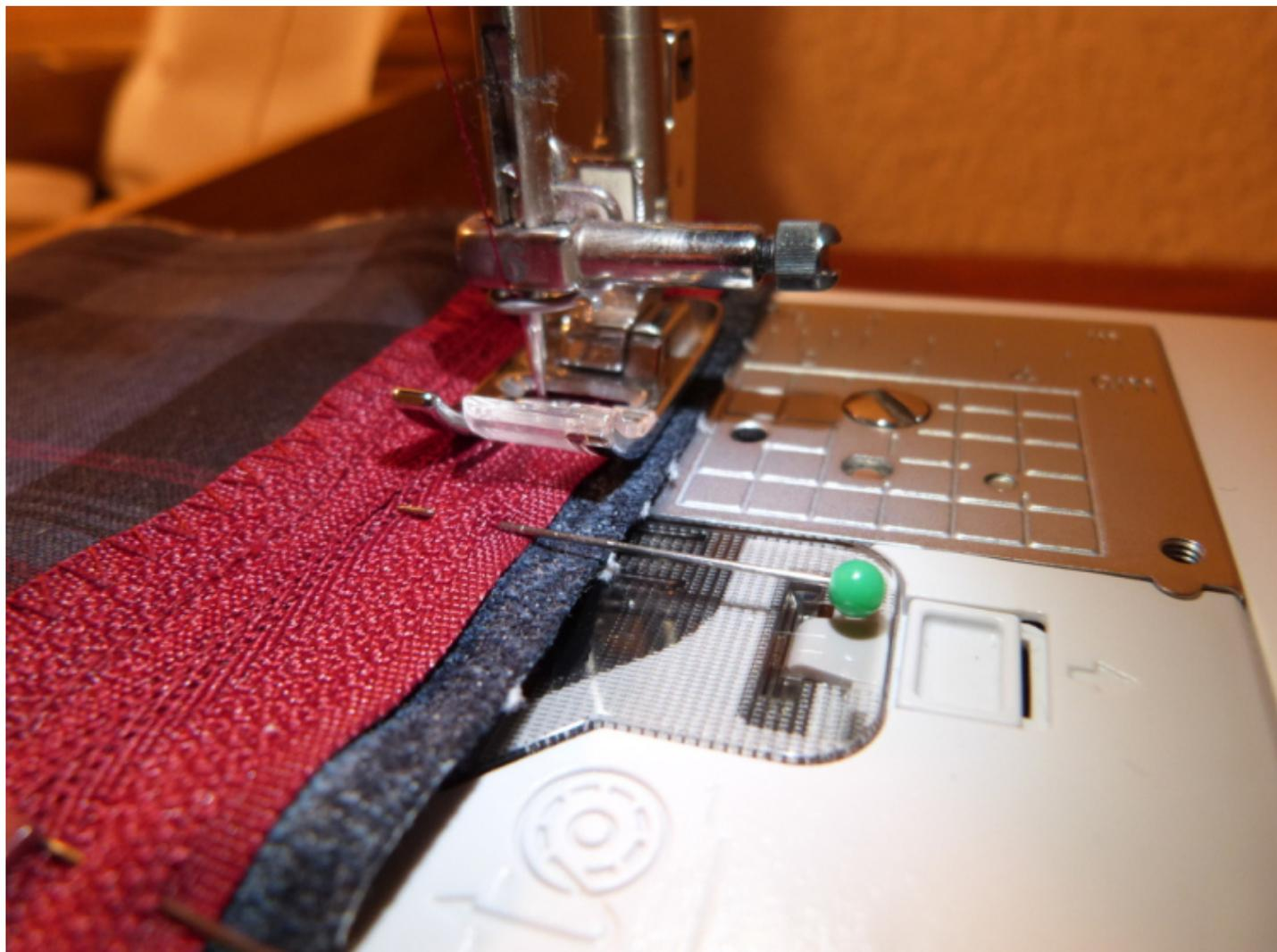
Puis repliez le fond de poche comme sur le schéma et cousez de nouveau à 1,5mm (et revoilà la sous-préfecte le décalage de 5 mm entre le bord de la fermeture et le bord du tissu)
